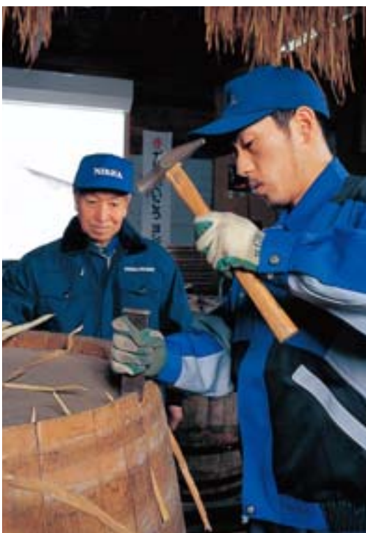
樽のメンテナンス作業。くさびを打ち込み、乾燥させたガマの葉を1本1本ていねいに差し込んでいく。はみ出した葉はちぎりとりながら、側板の間に残った葉は水分を含むとふくらみ、ウイスキーの漏れを防ぐ役割を果たす。使い込まれたくさびもまた、職人たちの手づくりのもの
